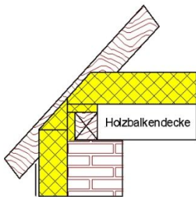
Außenwand und oberste Geschossdecke
